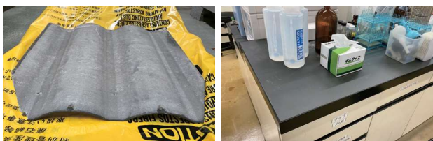
アスベスト含有のスレート屋根材(左)と試験研究用実験台
