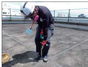
コンクリート下の防水材採取作業。ドリルでの採取(左)と採取された検体
