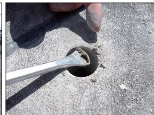
コンクリート下の防水材採取作業。ドリルでの採取(左)と採取された検体
